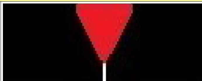
Saldatura incompleta, che lascia uno spazio vuoto alla radice, favorendo la corrosione
